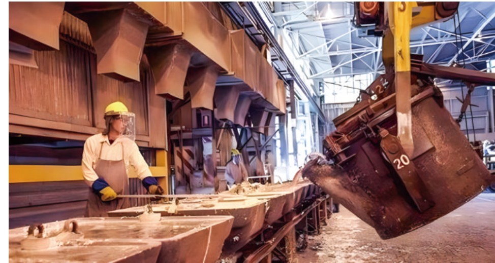
铝锭铸造 Aluminum Ingot Casting
